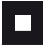
luce fissa visibile soltanto su un arco d'orizzonte limitato
